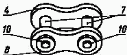
д — другие типы разборных соединительных звеньев (замки могут быть различной конструкции и на чертеже показано только их расположение)
